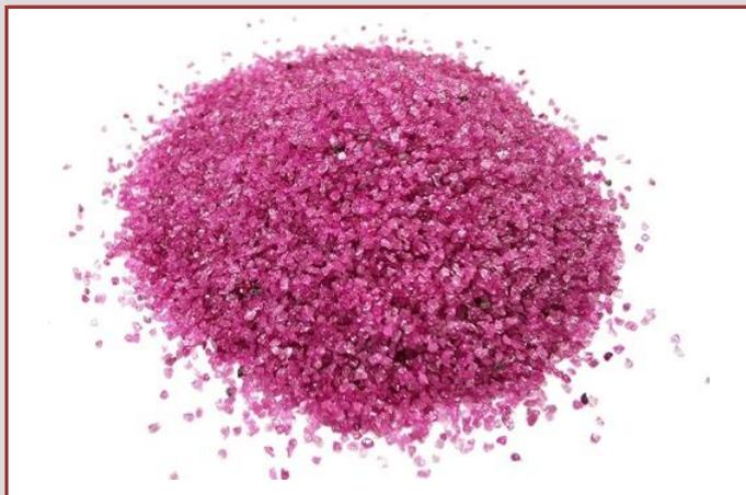
铬刚玉也称为粉红色熔融氧化铝、铬氧化铝或红宝石熔融氧化铝，缩写为“PA”。它是一种人工合成的刚玉磨料。在熔融过程中向高纯氧化铝中加入氧化铬，得到粉红色的氧化铝。氧化铬的添加量会影响最终产品的颜色以及晶粒的韧性。中铬铬刚玉的氧化铬含量为0.45-1%，颜色比高铬铬刚玉浅。韧性比高铬磨料略低，但是硬度比高铬铬刚玉高。适用于生产磨具制品和喷砂。
